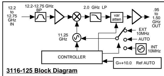
FIGURE 1.2 3116-125 Block Diagram
