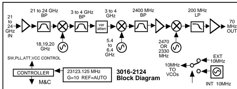
**FIGURE 1.2 Model 3016-2124 Downconverter Block Diagram**
