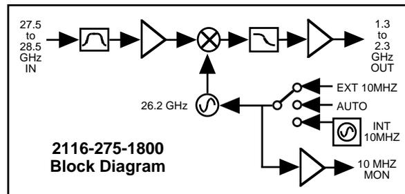
**FIGURE 1.2 Block Diagram**
