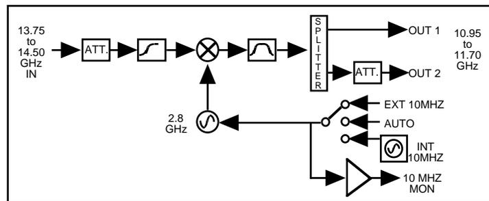
**FIGURE 1.2 Block Diagram**
