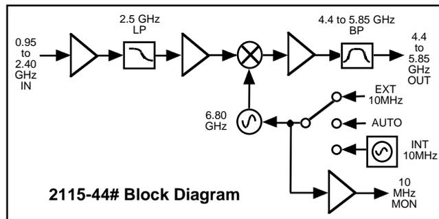
**FIGURE 1.2 Block Diagram**
