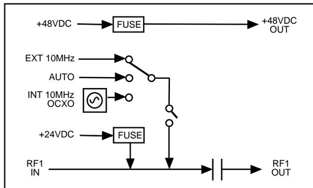
**FIGURE 1.2 Block Diagram**
