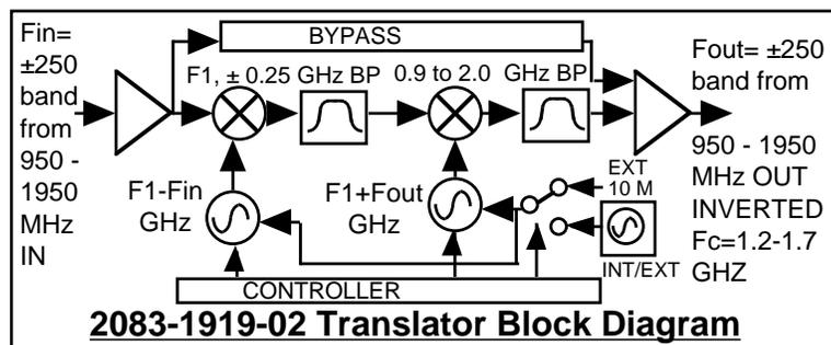
**FIGURE 1.2 2083-1919-02 Block Diagram**
