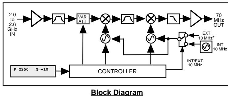
**FIGURE 1.2 Model 2016-2026 Downconverter Block Diagrams**
