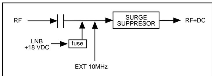
**FIGURE 1.2 Block Diagram**
